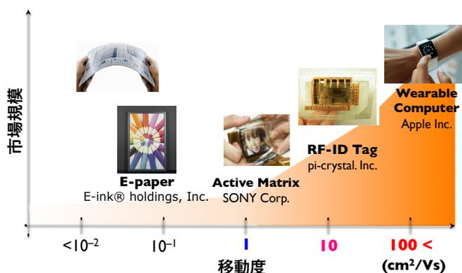
図 2. 有機半導体のキャリア移動度と市場規模の関係.
